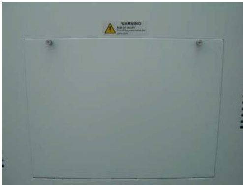
Малюнок 2-4 Зніміть задню панель аналізатора
