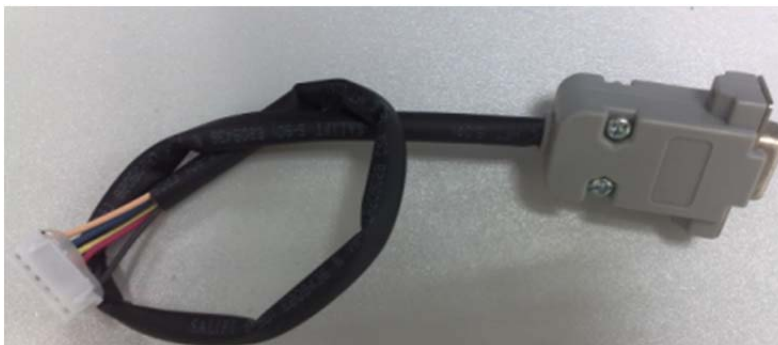
Рисунок В.2-1 Кабель завантаження програми для № 01 ~ 08 основних контрольних плат
