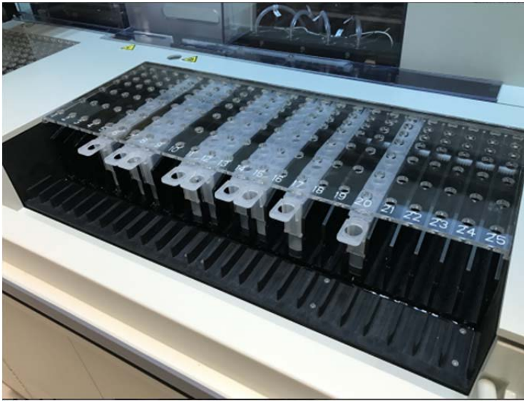
Рисунок 3.2-6 25 Доріжки реагентів в зоні реагентів
