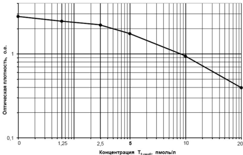
Рисунок. Пример зависимости оптической плотности от концентрации  $T_3$  св. в калибровочных пробах.
