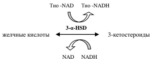
Скорость образования тио-NADH может быть измерена по росту адсорбции на 405 нм и прямо пропорциональна концентрации желчных кислот в пробе.
